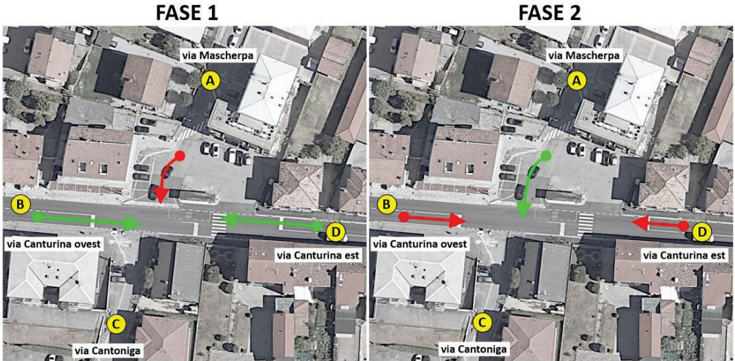
Figura 8 – Intersezione 4 – Fasi semaforiche
